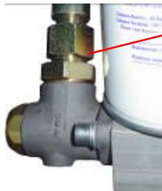
❖ **Клапан минимального давления:** служит для поддержания давления в системе компрессора и работает как невозвратный клапан во время холостого хода и остановки.
