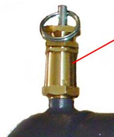
❖ **Предохранительный клапан:** служит для предохранения сосудов от превышения давления.
