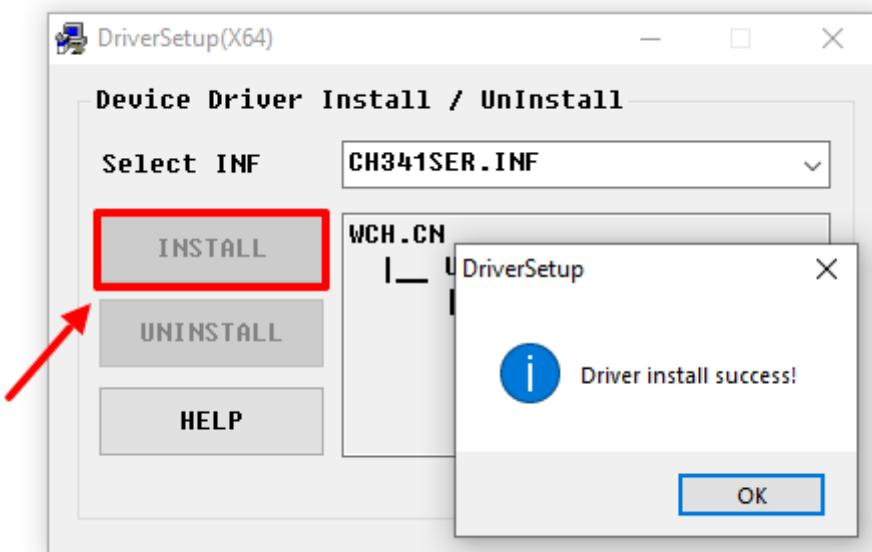
Запускаем и в появившемся окошке нажимаем INSTALL.
