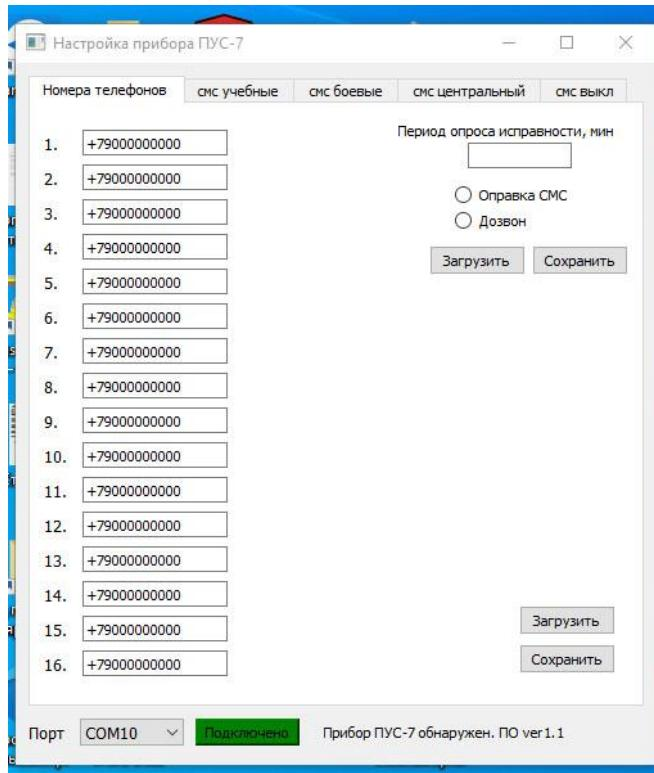
Появится сообщение **Прибор ПУС-7 обнаружен. ПО ver 1.1**. Если ранее прибор програмировался, после нажатия кнопки **Загрузить**, в правом нижнем углу, появится список записанных в память прибора телефонов. После редактирования номеров телефонов, следует нажать **Сохранить** (в нижнем правом углу)
